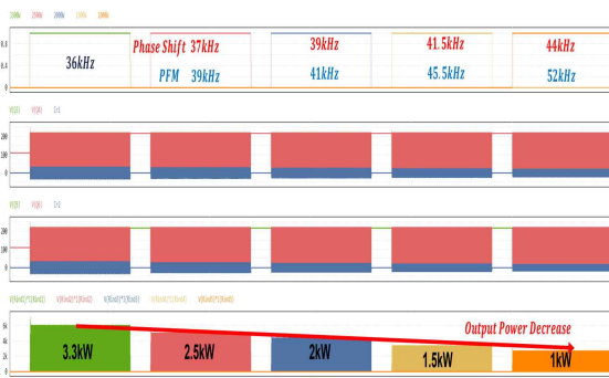
그림 4 PFM 방식을 이용한 전력 제어와 Hybrid Modulation을 이용한 전력 제어 시뮬레이션 파형 Figure 4 Power control simulation waveforms of PFM and Hybrid Modulation
