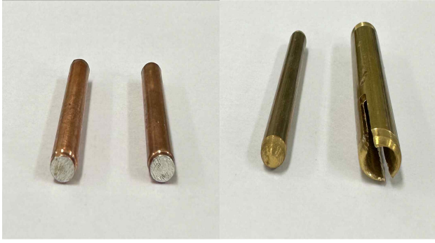
a) 접점형 전극 b) 소켓-플러그형 전극 그림 3 전극의 형상
