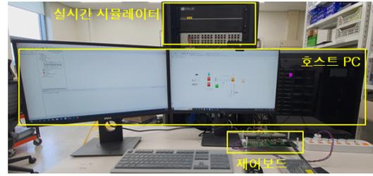
그림 5 Hardware-In-the-Loop-Simulation 시스템
