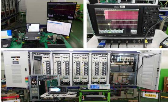
그림 5 GFM인버터의 시험 환경 구축 Fig. 5 Experimental setup of GFM inverter
