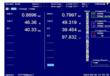
그림 9. 입력 870V, 출력 800V, 40kW 측정 효율
