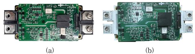
그림 1 선정 전력 모듈 및 게이트 드라이버, (a) SiC, (b) IGBT
