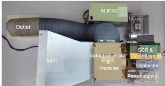
그림 4. 실험에 사용된 유도모터 및 소프트 스타터. Fig. 4. Induction motor and soft soft starter used in experiments.
