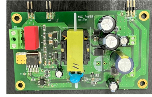
그림4 RCD 클램프를 적용하여 제작한 플라이백 컨버터
