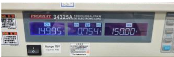
(b) 하프 브리지 최소 부하 동작 확인(150V/0.8A)
