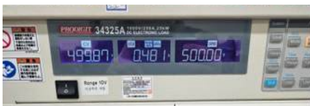
(a) 풀 브리지 최소 부하 동작 확인(500V/0.5A)
