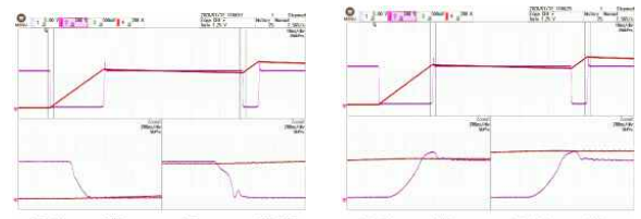
그림 2 더블 펄스 시험 파형 Fig. 2 Double Pulse Test Waveform
