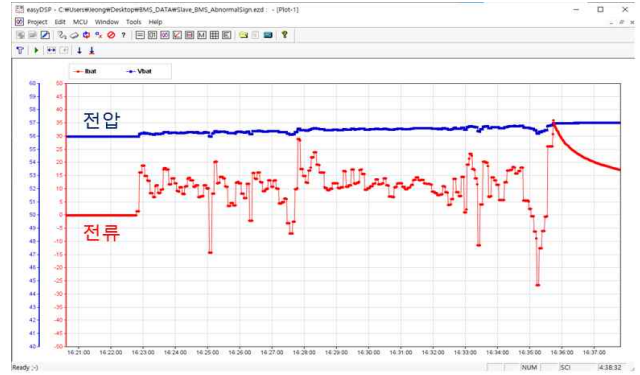
그림 6 배터리 셀 내부저항 추정을 위한 전압, 전류 측정 Fig. 6 Voltage and Current Measurement for Estimating Battery Cell Internal Resistance
