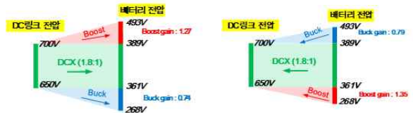
그림 2. 배터리 전압 범위에 따른 DC 링크 전압. (a) 충전, (b) 방전
