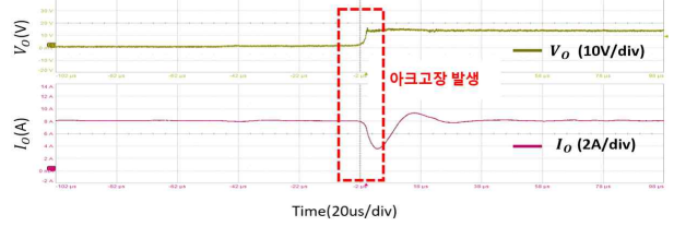
그림 6 아크고장 시 LCL필터 출력파형
